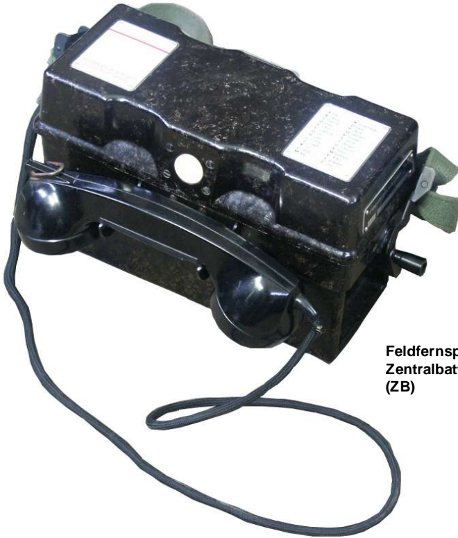
Feldfernsprecher im Wahlbetrieb mit auf- gesetztem Wahlzusatz.
