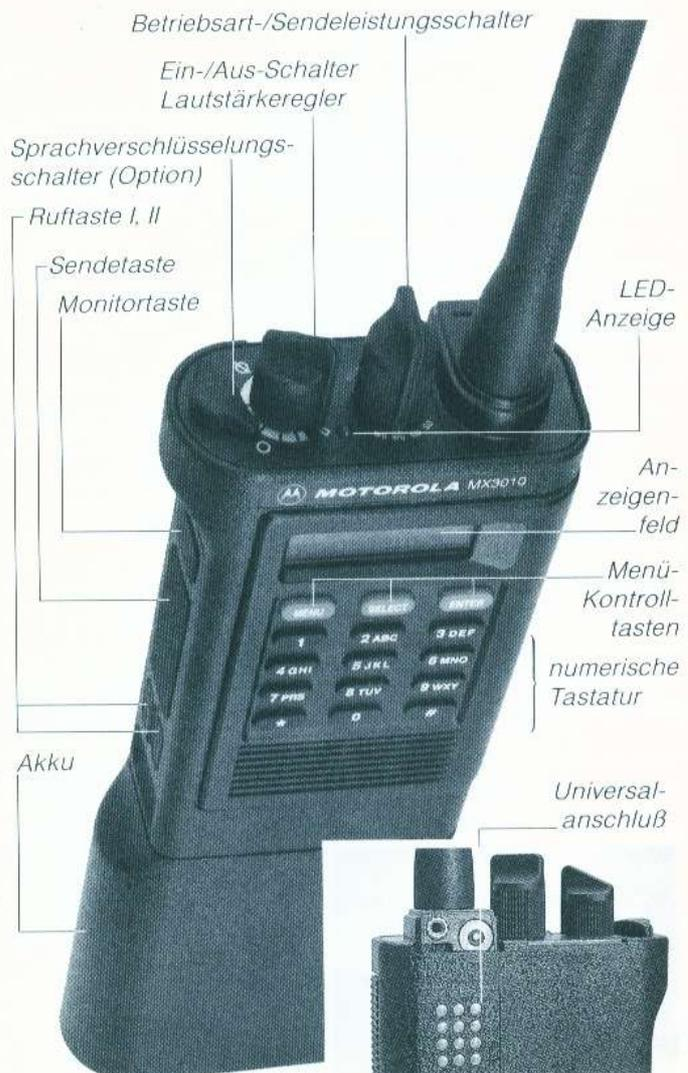
Die Umschaltung von Betriebsart und Sendeleistung erfolgt über einen Kombinationsschalter an der Geräteoberseite. Die Anzeige der gewählten Schaltstellung im beleuchtbaren Display ermöglicht eine sichere Bedienung auch bei Dunkelheit.
