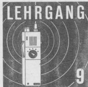
Die Funksprechstation UFS 401 arbeitet im Prinzip nach der unter „Wirkungsweise eines Funkgerätes“ (Heft 6 und 7/1974) beschriebenen Weise. Der Sender der Anlage ist vollständig und der Empfänger teilweise mit Röhren bestückt. Daraus resultiert auch die gegenüber den moderneren Anlagen der UFS-600-Reihe höhere Leistungsaufnahme aus der Batterie. Die für die Röhren erforderliche Anodenspannung und Gittervorspannung wird von einem Gleichspannungswandler aus der Batteriespannung umgeformt.
