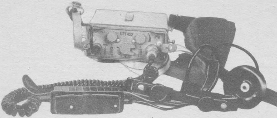
daß gerade kein Rauschen mehr zu hören ist. Bei ungünstigen Empfangsbedingungen kann die Rauschsperrung außer Betrieb gesetzt werden. Schwach einfallende Signale sind dann noch aufnehmbar. Das auftretende Rauschen muß jedoch dabei in Kauf genommen werden.
