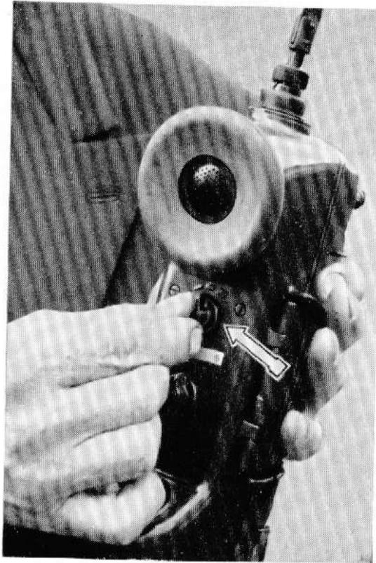
Abb. 9 Halten des Handfunkgerätes beim Sprechen
