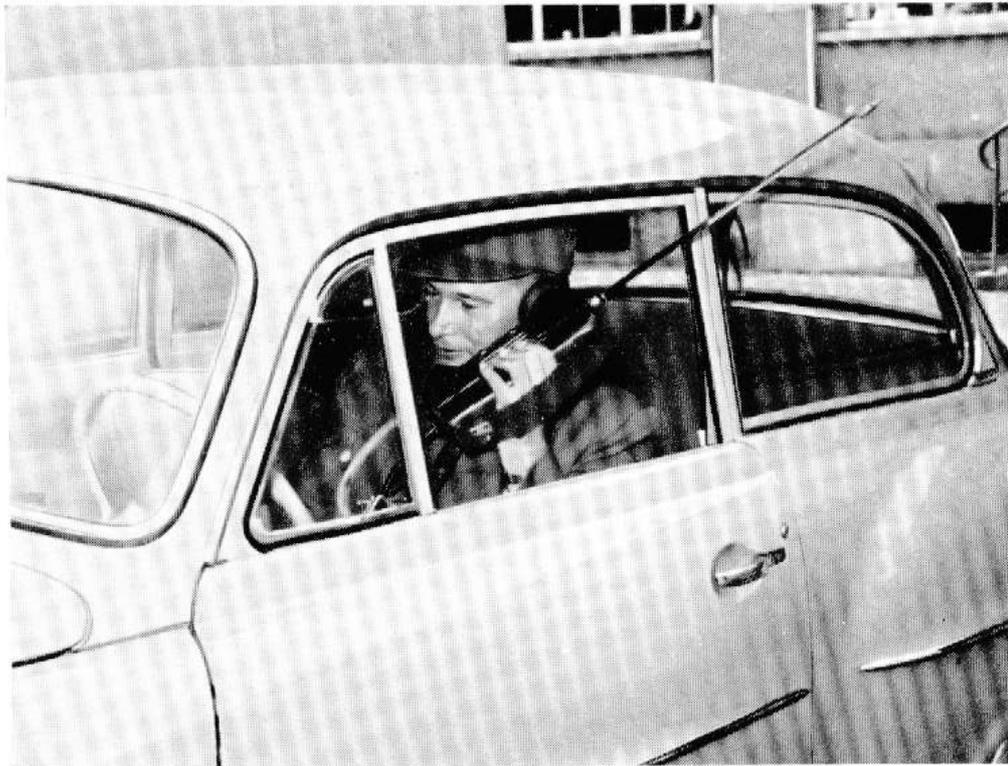
Abb. 10 Beispiel für den Einsatz des Handfunksprechers in einem Personenkraftwagen. Die Antenne wird durch das geöffnete Fenster gehalten.
