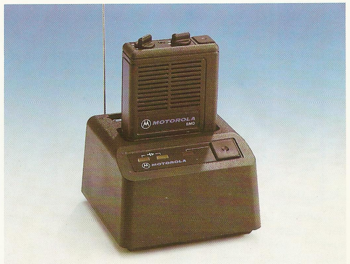
BMD Heimzusatz mit integriertem Ladefach für Ersatzakku und Antennenanschluß.
