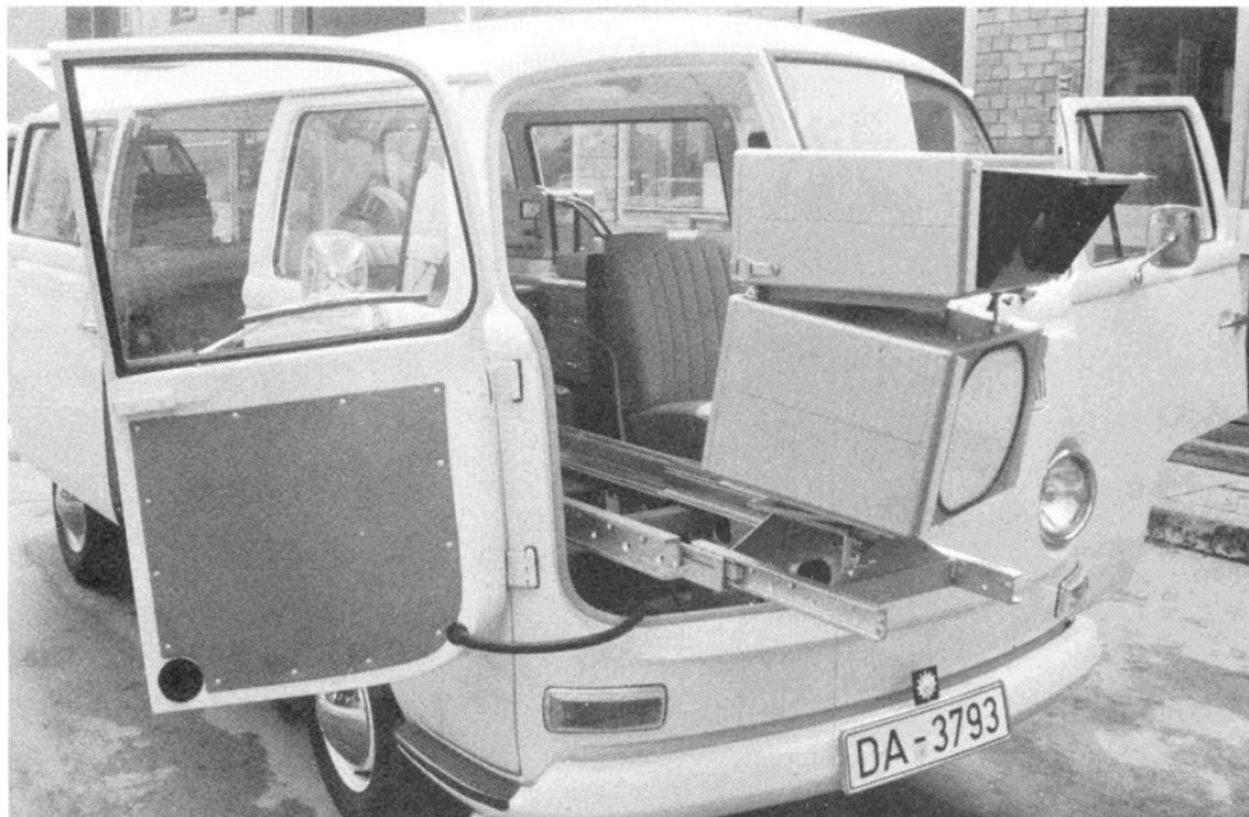
Der 3FG war der erste Radar welcher in ein Fahrzeug eingebaut werden konnte. Kurze Zeit später folgte der MU 3FAG welcher den abfließenden Verkehr mit zwei Fotos dokumentierte.
