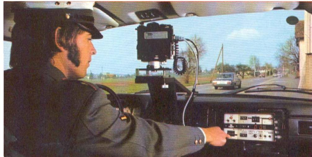
5F Radar löste das Problem der Zuordnung bei mehreren Fahrzeugen mittels Schablonen Auswertung.
