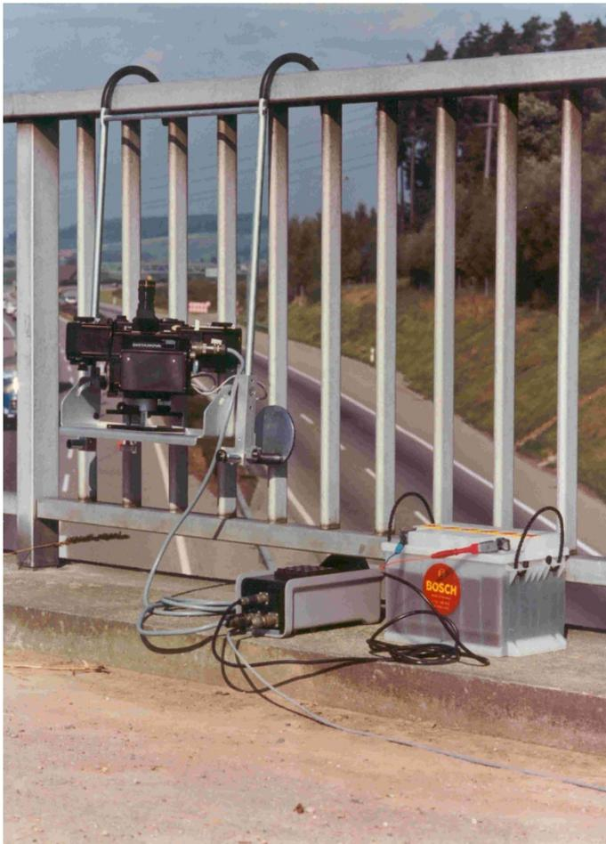
Bei Distanova handelte es sich um ein fotografisches Sicherheitsabstandsmessgerät. Es erlaubt, zu geringe Fahrzeugabstände zu erfassen. Leider wurde wegen geringem Interesse bei der Polizei das Produkt 1983 wieder aus dem Sortiment entfernt.
