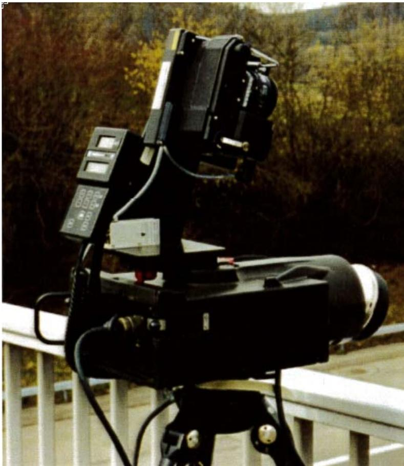
Fotographierendes Radargeschwindigkeitsmessgerät. Es ist besonders gut für den Einbau in Personenwagen geeignet, lässt sich aber auch auf ein Stativ neben der Fahrbahn oder auf einer Brücke über der Fahrbahn aufstellen. Später folgte der 6FA (1986) und 6FM (1991)
