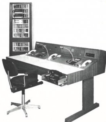
Bild 3 Bedientisch mit 2 Abfrageplätzen für AVF 2000
