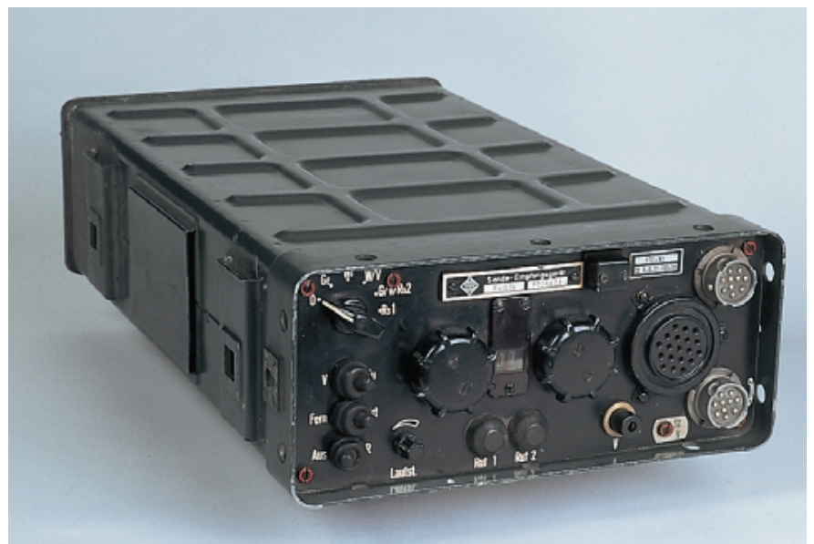
Bild 6 Durch Weiterentwicklung konnte das FuG 7 ab 1955 durch das verbesserte FuG 7a ersetzt werden.
