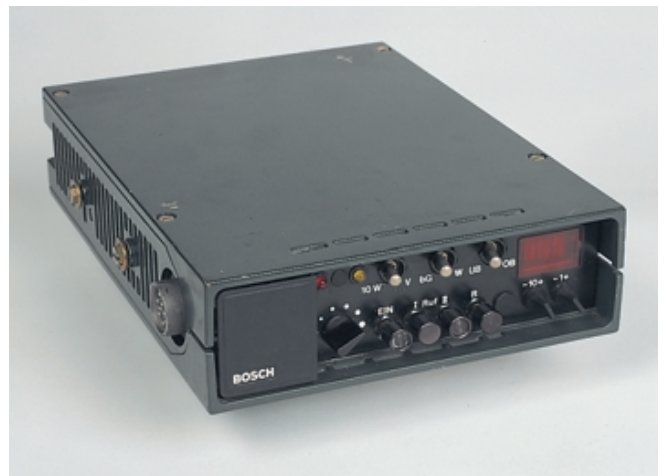
Bild 10 Das KF 801 der Firma Robert Bosch GmbH, ein Vielkanal-Fahrzeug-Funkgerät, erfüllte 1974 nicht die Anforderungen nach der Richtlinie für das FuG 8 a/b. Deshalb wurde die Produktion schnell wieder eingestellt.
