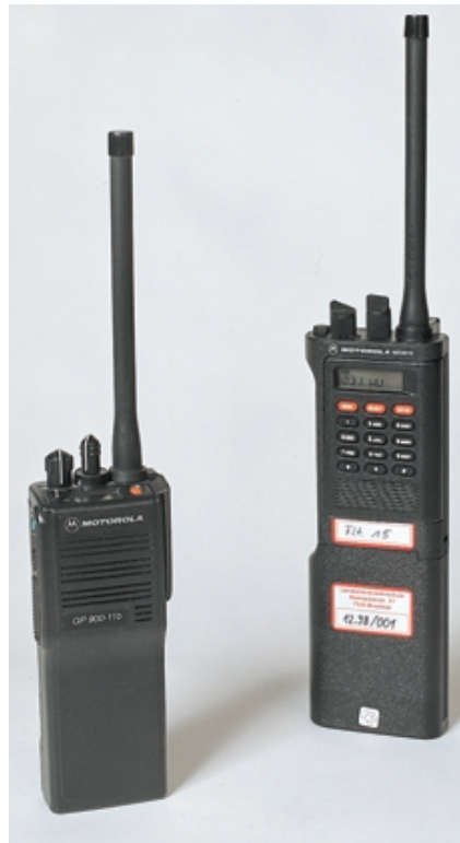
Bild 16 Ein FuG 13b (rechts) für das 4-Meter-Band neben einem FuG 11b (links) für das 2-Meter-Band.
