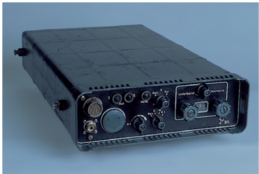
Bild 8 Das Funkgerät SEM 27-820 GWL der Firma Standard Elektrik Lorenz verfügte über das 20-kHz-Raster. Es wurde von 1961 bis 1967 gebaut.
