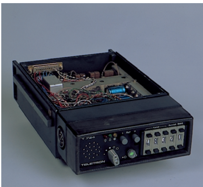
Bild 11 Beim FuG 8b sind 111 Kanäle schaltbar. Hier wird der Prototyp gezeigt, ein Gerät der Firma Teletron.
