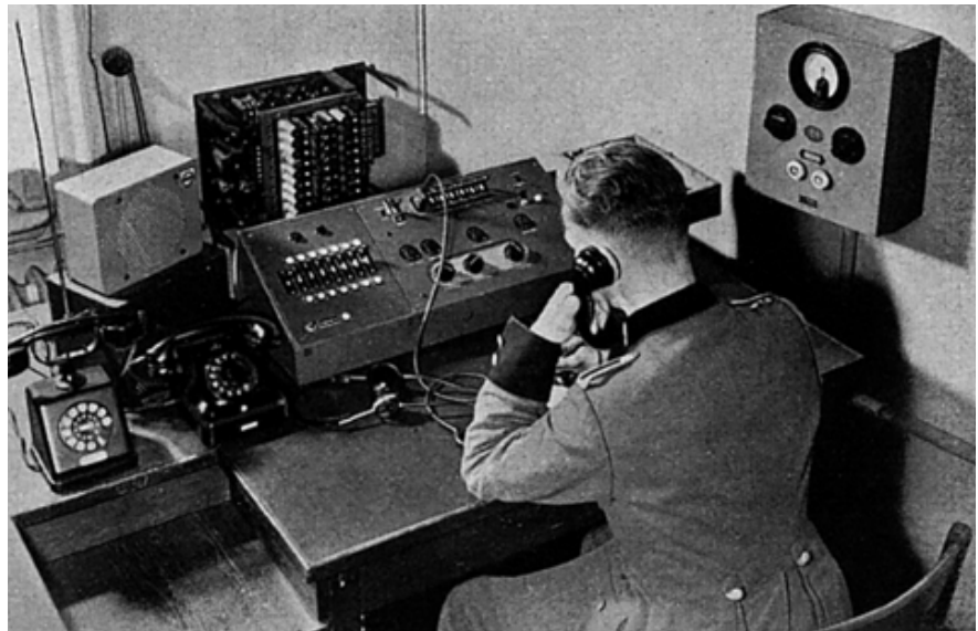
Bild 3 Mit dieser Vermittlung konnten beim 1943 aufgebauten Netz der Hansestadt Hamburg Funkgespräche in das Fernsprechnet übergeleitet werden.
