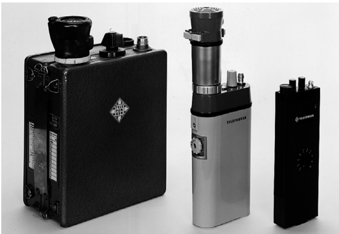
Bild 15 Nach der Einführung der Transistortechnik wurden die tragbaren Sprechfunkgeräte stetig verkleinert. Von links: AEG Tele- port V (ab 1959), Teleport VI (ab 1963), Teleport VII/FuG 10 (ab 1974). [Foto: AEG]
