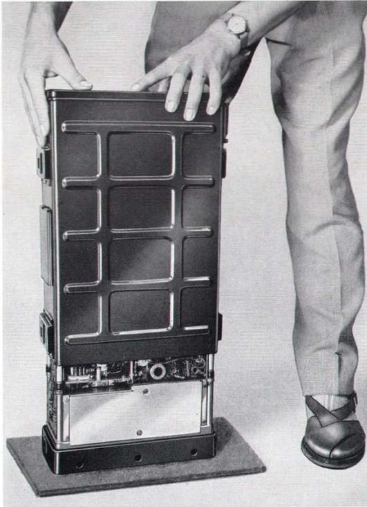
Bild 18 Abziehen des Gehäuses vom SE-Gerät
