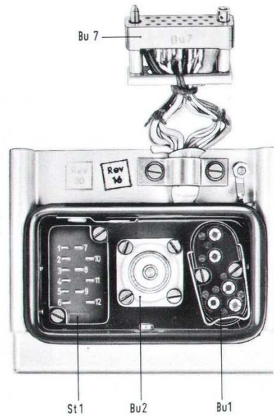
Bild 64 Baustein 4, Buchsenseite siehe dazu auch untenstehende Legende.
