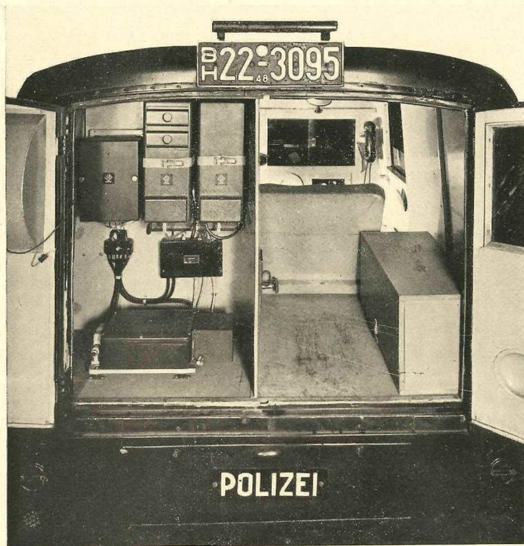
Einbau der TELEFUNKEN - FM - UKW - Funksprechgeräte
