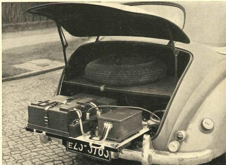
TELEFUNKEN-Funksprechanlage im unteren Teil
