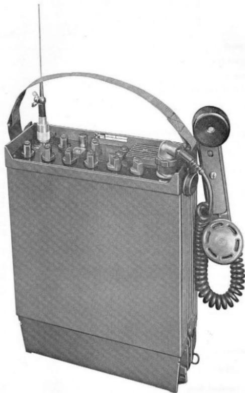
Bild 1. 240-Kanal-Sprechfunkgerät FuG 7 b (Sende-Empfangsgerät mit darunter befestigtem Batteriekasten)
