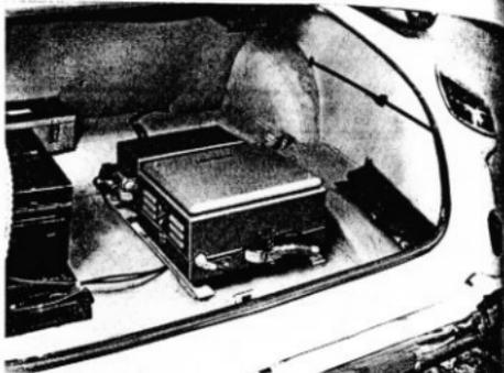
Geräteblock und dahinter Invertergehäuse auf verlängerten Montageschienen im Kofferraum eines „Opel Kapitän“ angeordnet; links daneben 12-V-Zusatzbatterie für die Funkeinrichtung.
