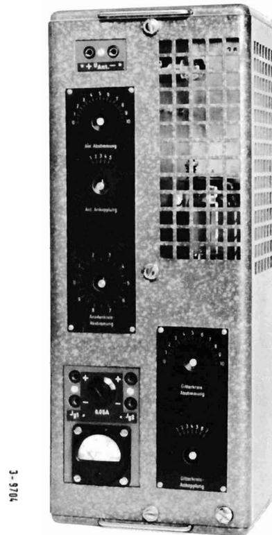
Bild 12 80-MHz-Leistungsendstufe (100 W) S 120/2
