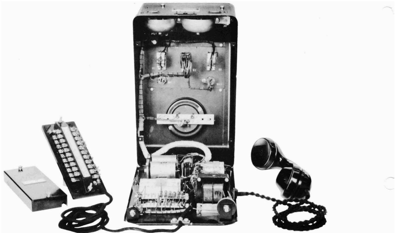
Bild 56 Betriebszentrale BeZ 107/20, geöffnet, mit Anschlußeiste
