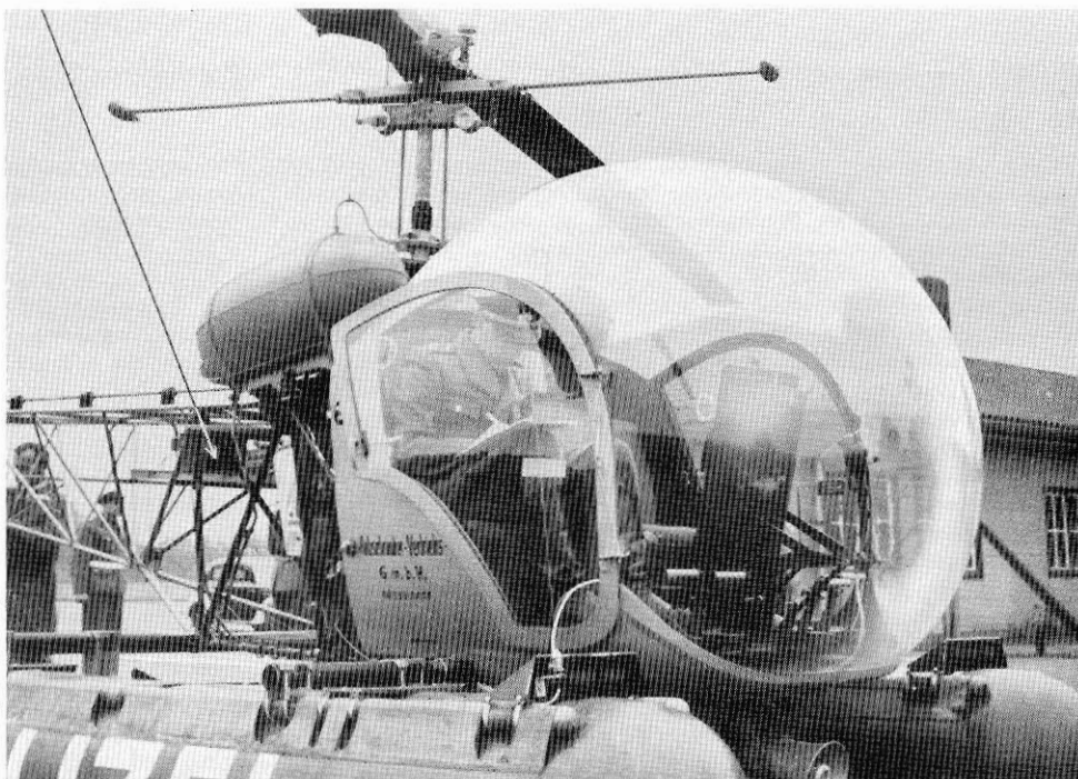
Bild 3: Einbau des Gerätes Fu G 7 in einem Hubschrauber. Das Gerät steht bequem bedienbar zwischen den Knien des Funkers und ist hier schlecht zu erkennen. Eine andere Anordnung s. Bild 22 des Aufsatzes A. Hagen auf S. 19. Links hinten die Bordbatterie.
