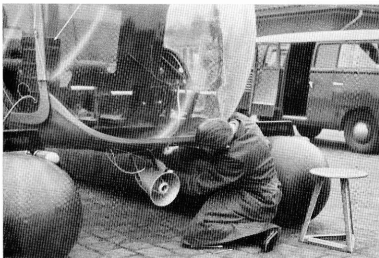
Bild 4: Einbau des Lautsprechers.
