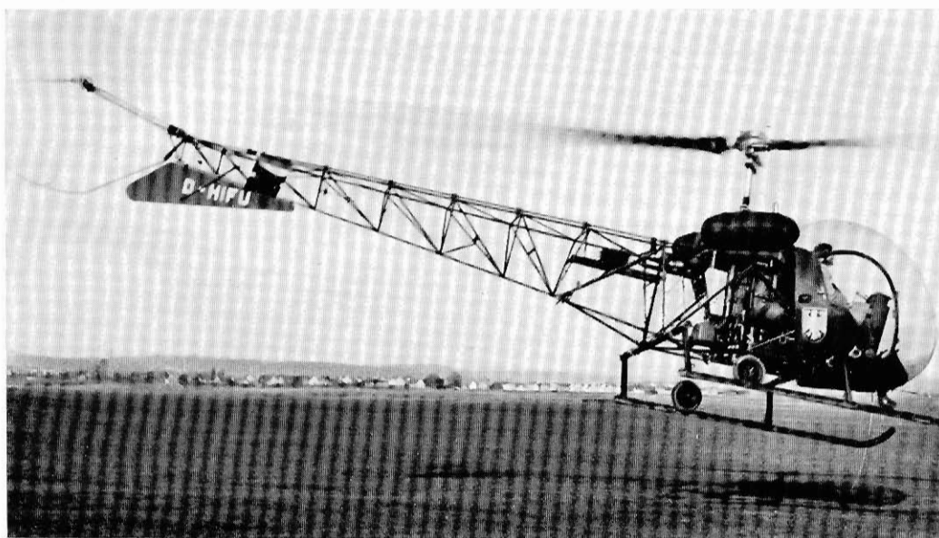
Bild 23: Hubschrauber im Flug mit nach unten ausgefahrner Antenne für Fu G 7-Gerät
