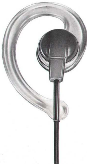
Bild 4.30 Magnetischer Hörer HM 33 in natürlicher Größe (3-13 317)
