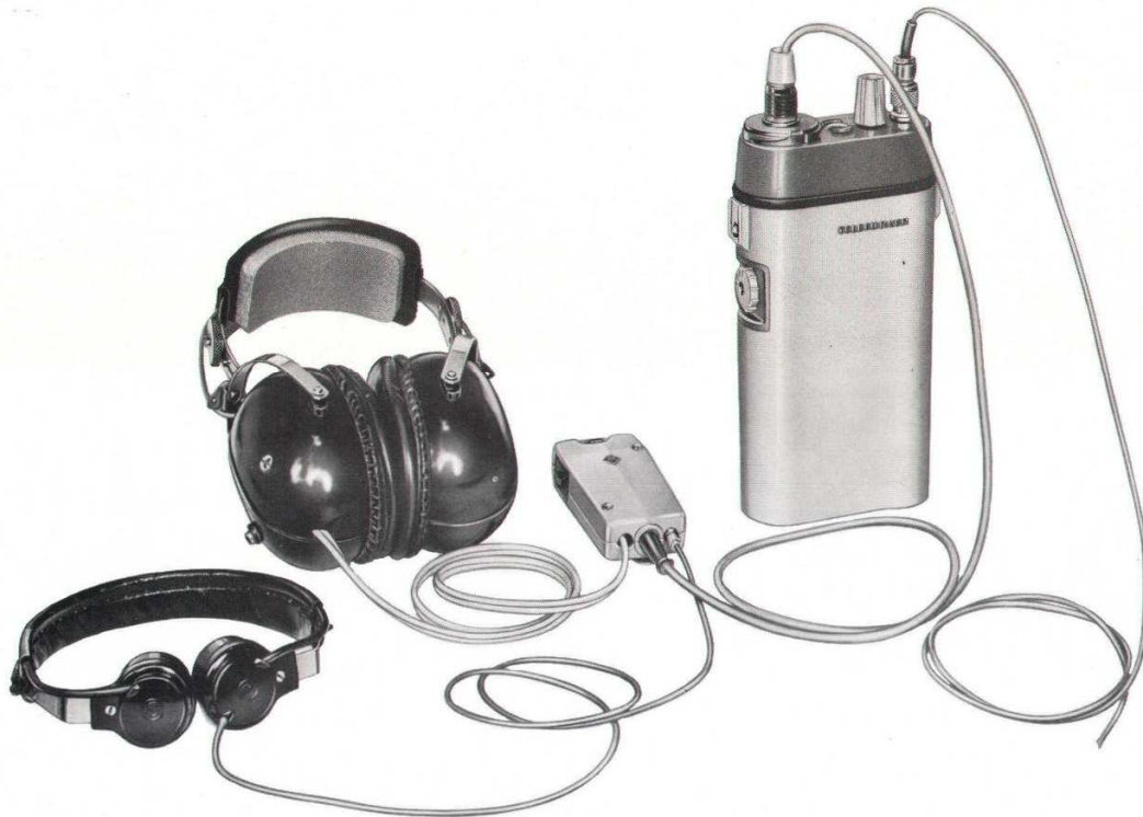
Bild 4.31 TELEPORT VI mit Hör- und Sprechgarnitur für lärmgefüllte Umgebung, etwa in einem Viertel natürlicher Größe (3-14 306)
