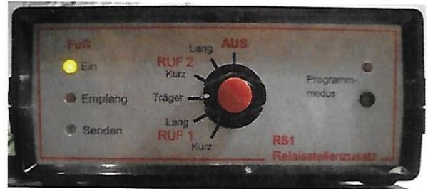
Der Relaisstellenzusatz ist zum Anschluss an BOS Funkgeräte (FuG 7b,8b,8c,9c) ausgelegt und dient zum Aufbau einer kleinen Relaisfunkstelle (RS1). **Bei einem bestehenden Relaisbetrieb darf der Relaisstellenzusatz nicht in Betrieb genommen werden, da sonst Störungen des Funkverkehrs auftreten können !**
