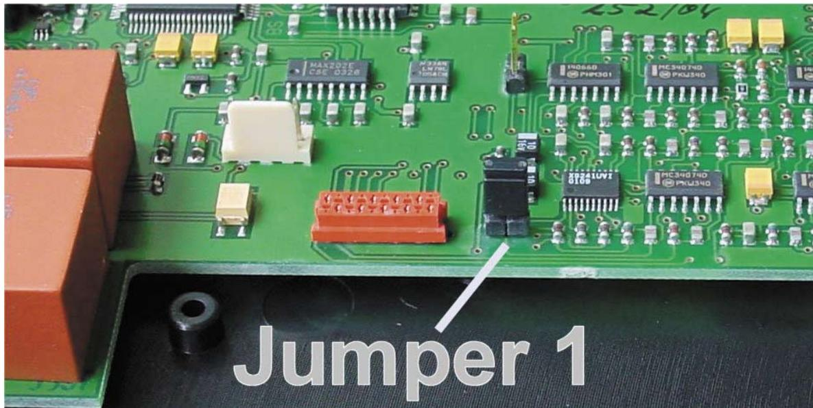
Der Major 4a (5a) kann sowohl für Zweidraht- als auch für Vierdraht-Anbindung konfiguriert werden. Für Zweidrahtanbindung ist Jumper 1 wie auf dem Foto zu stecken. Für Vierdraht einfach den Jumper 1 entfernen.
