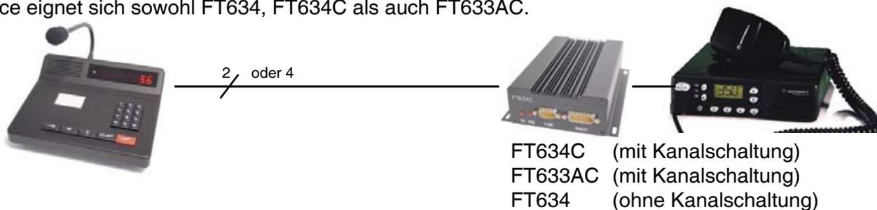
Soll die vorgenannte Konfiguration über eine Post-Mietleitung durchgeführt werden, empfiehlt sich nachfolgende Anordnung.
